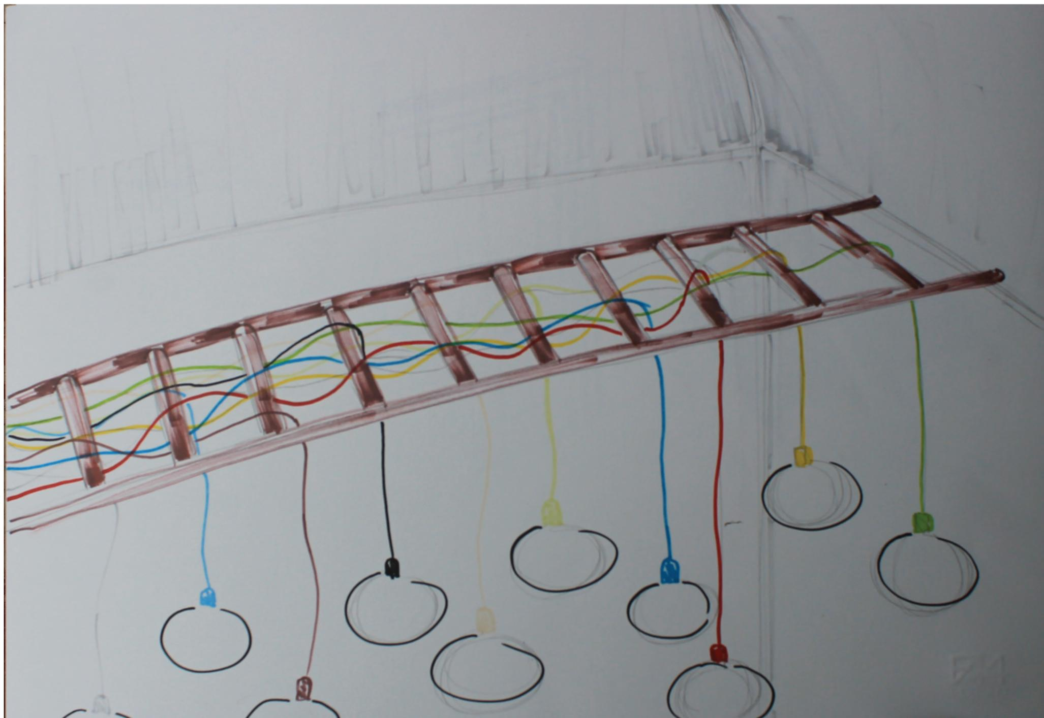
Il progetto prevede l'installazione della scala in posizione orizzontale, tramite tiranti d'acciaio alle pareti. Il passaggio di fili elettrici colorati con relative lampadine permetterebbe di trasformare la scala in un lungo lampadario.
